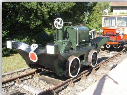
Locomotive "Moïse 5Ta" ("bête à cornes") pour tracter les locotracteurs et wagons.
